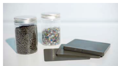
プラスチックパッケージからリサイクルされたベレット（左の瓶の中・粒状の物）。
