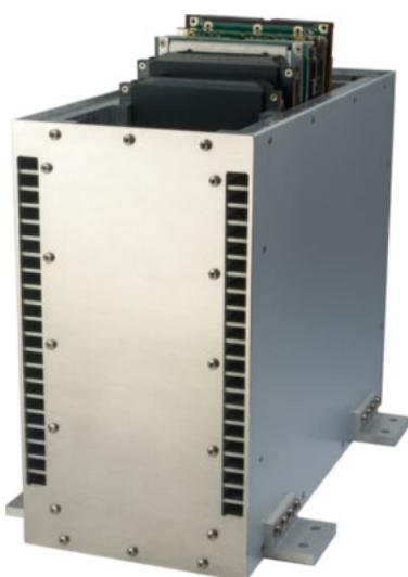
Ein «Air Transport Rack» mit OpenVPX-Technologie der Elma leistet seit Januar 2019 Dienst auf der Internationalen Raumstation (ISS). Elma lieferte das System im ersten Halbjahr 2018 an die russische Firma SAIT Ltd, die mit der Weltraumorganisation RSC Energia zusammenarbeitet. Das System ist Teil eines Broadband-Communication-System-User-Terminals, das über einen Satellitenverbund eine «nahezu permanente» Verbindung der ISS mit der Bodenkontrolle herstellt.
