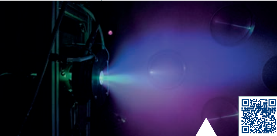
Ensayos del primer prototipo de Helicon Plasma Thruster (HPT). Test of the first Helicon Plasma Thruster (HPT) prototype.
