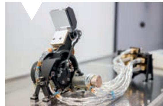
Mecanismo de calibración y obturación del escáner Meteosat Tercera Generación (MTG). Calibration and obturation mechanism for the Meteosat Third Generation scanner.
