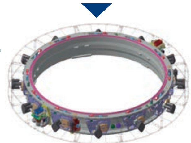
Mecanismo internacional de atraque y acoplamiento (IBDM). International Berthing and Docking Mechanism (IBDM).
