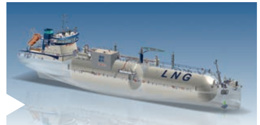
Vista simulada de los tanques de un buque de suministro de gas natural licuado (GNL). Artistic view of the storage tanks on a supply Liquefied Natural Gas (LNG) vessel.
