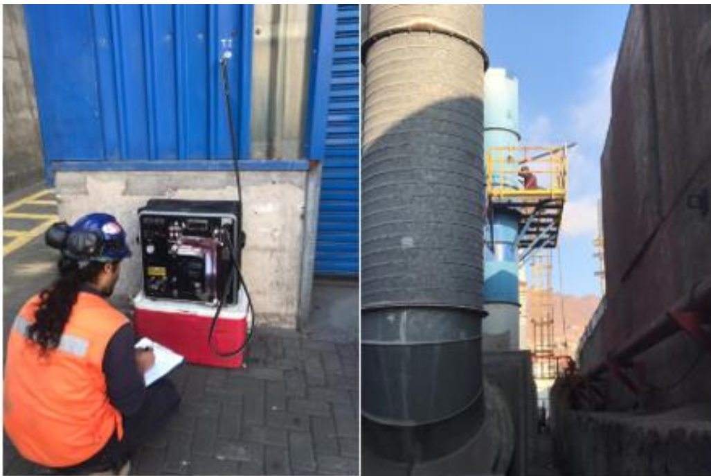
Proceso de medición de presión en galpones, y muestreo en fuente del sistema de control de material particulado.
