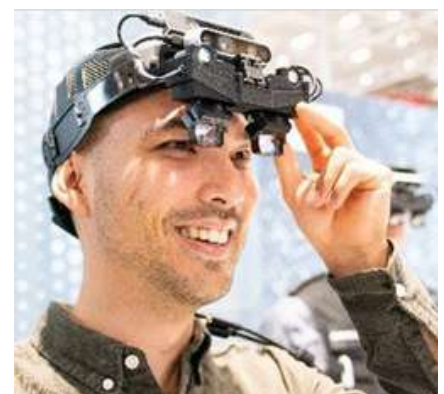
AR-Assistenzsystem, ausgestattet mit stromsparenden 720p OLED-Mikrodisplays
