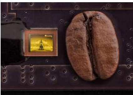
OLED-Mikrodisplay mit den weltweit kleinsten Pixeln
